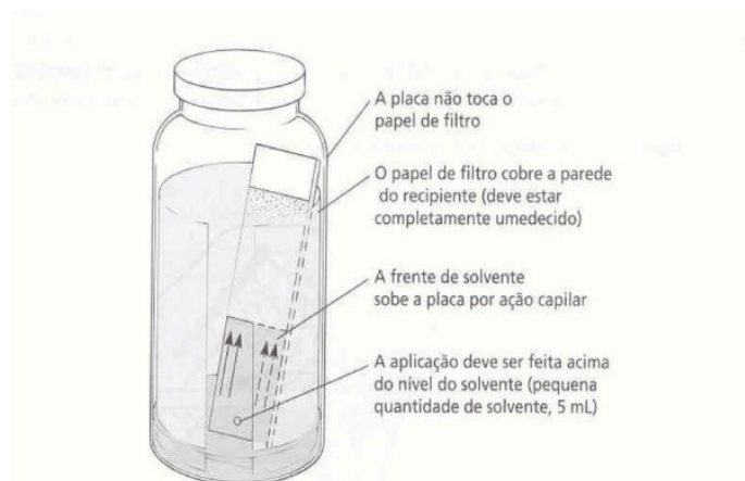
Figura 20.4 Câmara de desenvolvimento com uma placa de cromatografia em camada fina.
