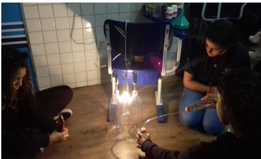
Figura 12. Alunos realizando o experimento que relacionou a variação da temperatura do sistema com a variação da concentração de \text{CO}_2 .
