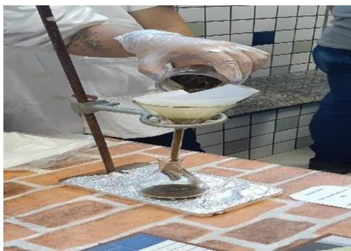
Filtração com solo e HCl
